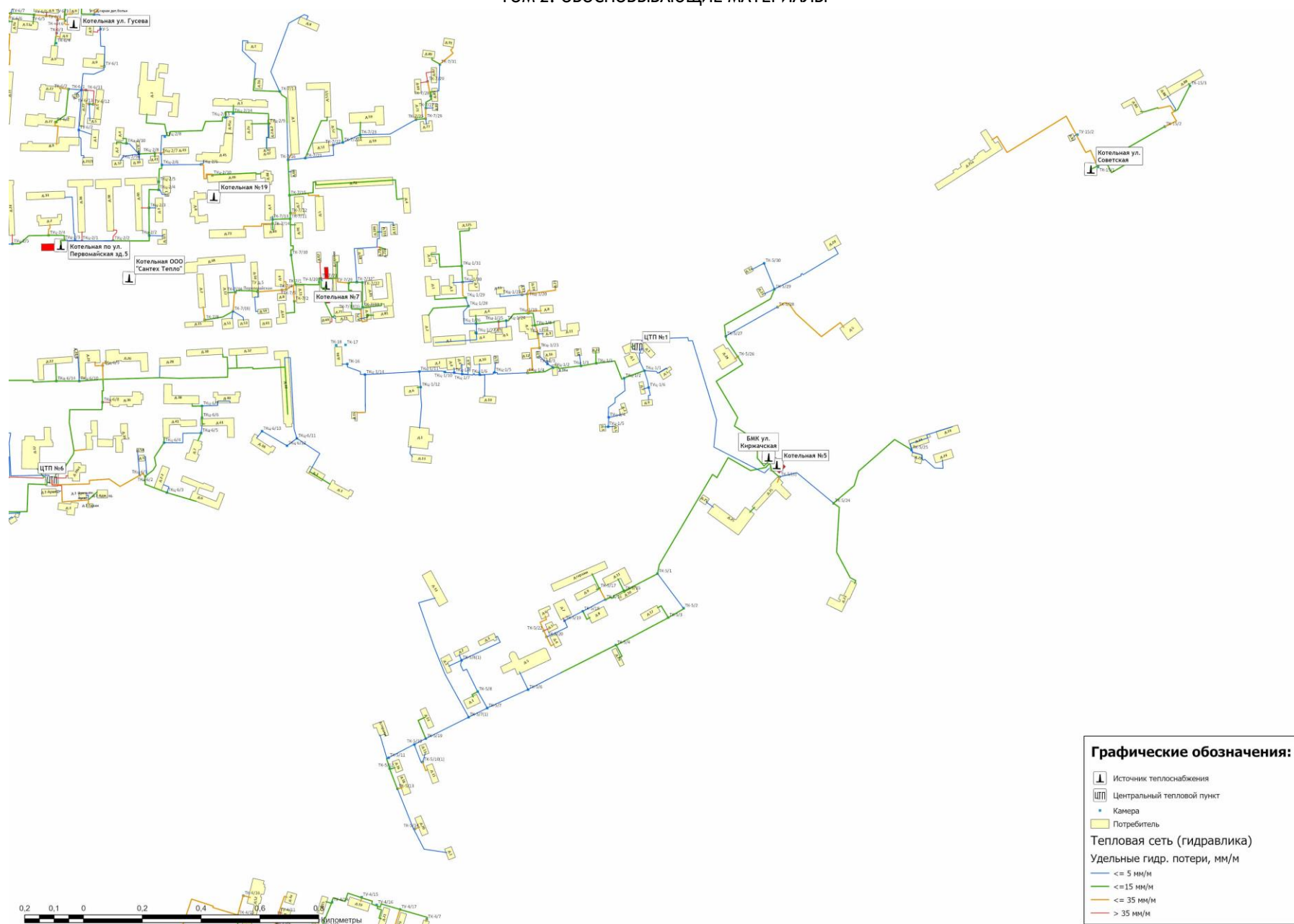
Рисунок 3.4.2 - Удельные гидравлические потери давления в трубопроводах тепловых сетей на территории г. Александров - часть 2
